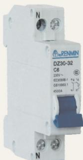
DZ30-32小型断路器（以下简称断路器），适用于交流50Hz或60Hz、额定工作电压230V、额定电流32A电路中，额定短路分断能力不超过4500A的保护配电线路上，作为线路不频繁接通，分断和转换之用，具有过载、短路保护功能。
